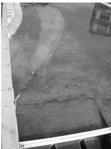
Slika 7: Preoblikovanje dna natočnega dela akumulacijskega bazena HE Boštanj – levo izhodiščna oblika dna, desno končna oblika dna
